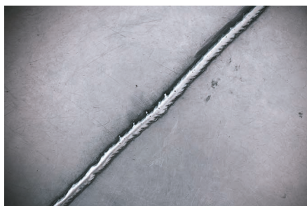
Cordão de soldadura e lixagem de rebarbas
