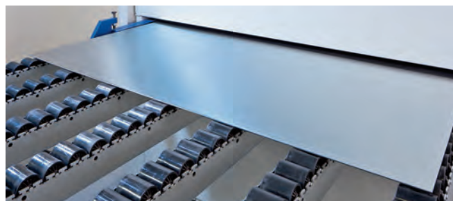
Rebarbagem e lixagem geral de superfícies
