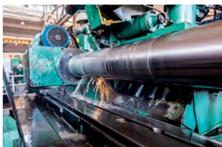
Retificação a húmido de rolos e cilindros
