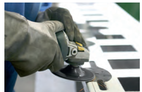
Rectificado de chapas y juntas de soldadura
