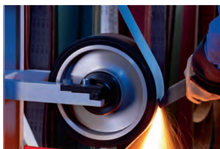
Desbarbado de acero
