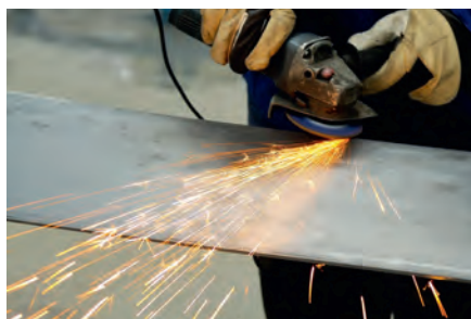
Mecanizado de planchas de acero
