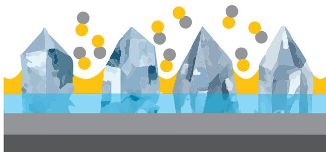
El sistema antiadherente (en amarillo) liga el polvo de lijado. El rendimiento se alarga notablemente.
