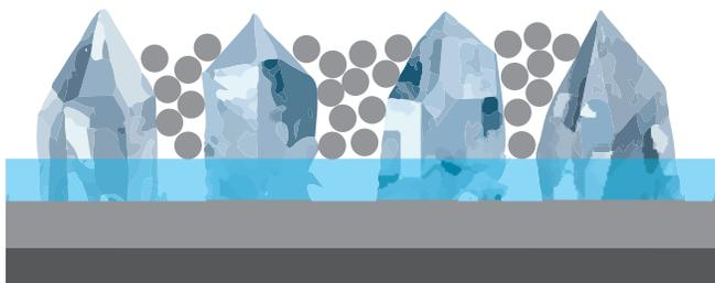
Sin sistema antiadherente – el polvo del lijado emboza el disco abrasivo. Baja el rendimiento de lijado.
